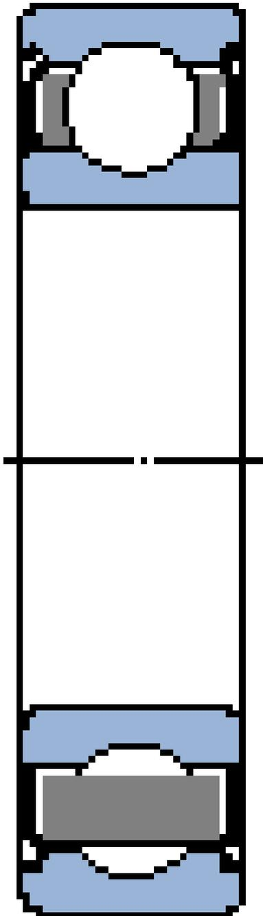
**6219-2Z/VA228 SKF Hochtemperatur-Rillenkugellager, einreihig**
