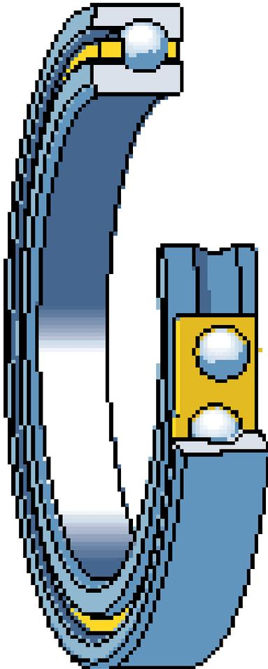
**FPCA 412 SKF Dünnring-Rillenkugellager FPCA**
