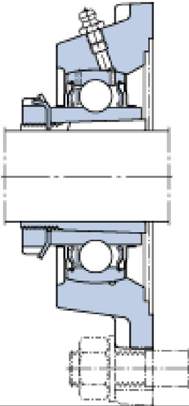
**FYJ 55 KF SKF Flanschlagereinheit FYJ..KF quadratisch 4-Loch**
