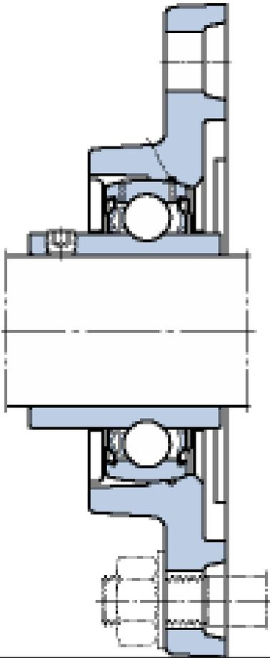
**FYTB 40 TF SKF Flanschlagereinheit FYTB..TF oval, 2-Loch**
