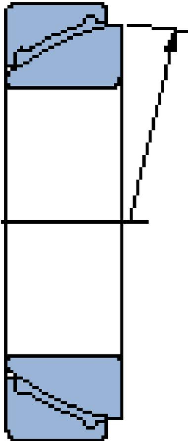
**GAC 35 F SKF Schräg-Gelenklager GAC..F, wartungsfrei**
