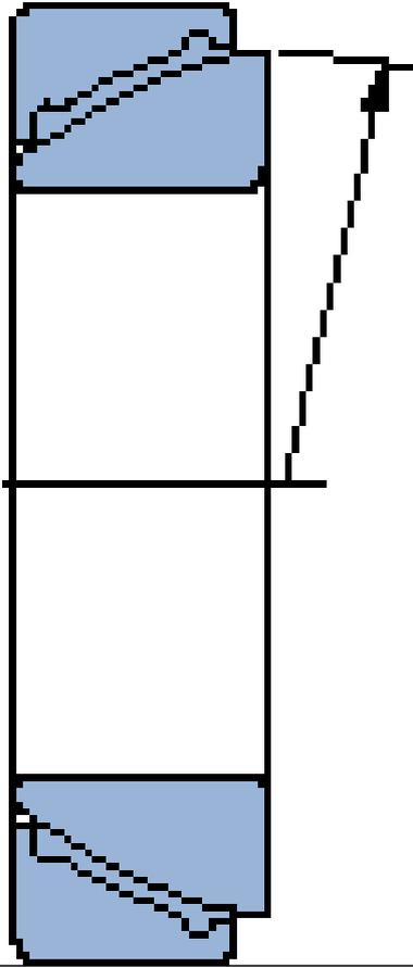
**GAC 45 F SKF Schräg-Gelenklager GAC..F, wartungsfrei**
