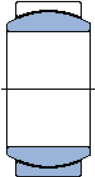
**GE 10 C SKF Radial-Gelenklager GE..C, wartungsfrei**
