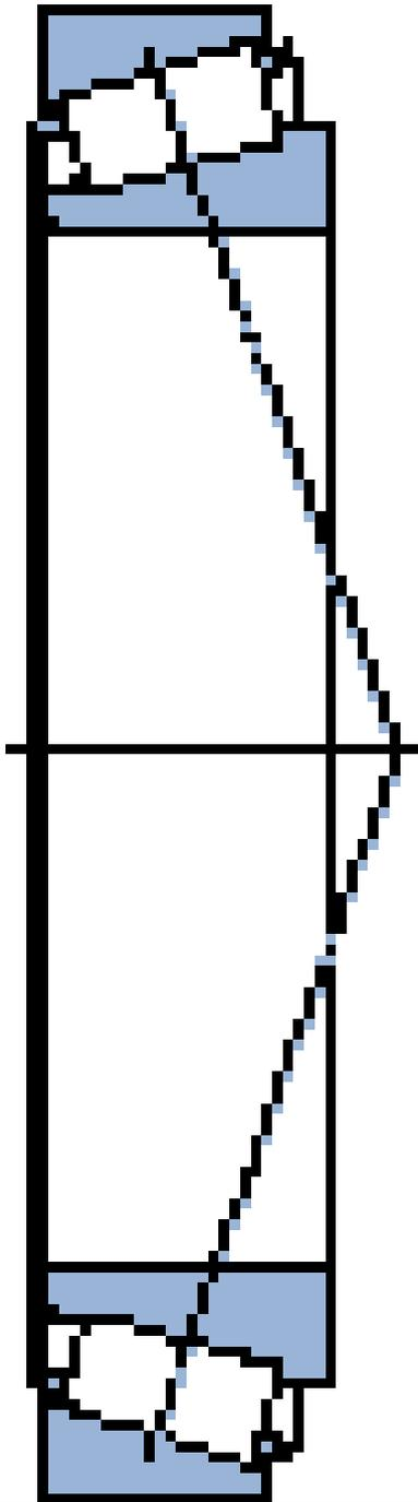
**30228 SKF Kegelrollenlager, einreihig**
