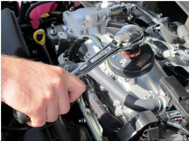
**FACOM E.506-200S elektronischer Drehmoment-Winkel-Adapter 200NM**
