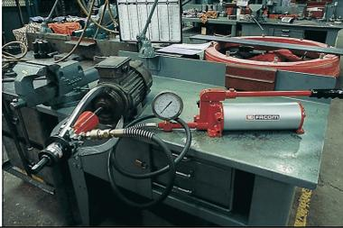
**FACOM U.320H Hydraulischer Aussenabziher 3 Armig, Spannb. 100-3**
