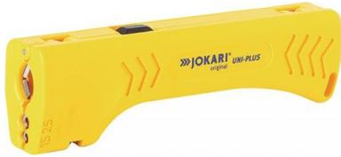
JOKARI Abmantelungswerkzeug Uni Plus Gesamtlänge 130 mm Arbeitsbereich Ø 8,0 - 15,0 mm 1,5 u. 2,5 (Litze) mm<sup>2</sup> · zum Entmanteln von NYM-Kabeln · für Rechts- und Linkshänder · Abmantelung der schweren äußeren Isolierung und Abisoliermöglichkeit für die Litze durch wechselbaren Anschlag · NYM-Kabel 3 x 1,5 mm<sup>2</sup> bis 5 x 2,5 mm<sup>2</sup> = Feuchtraumkabel · auch für Gummikabel
