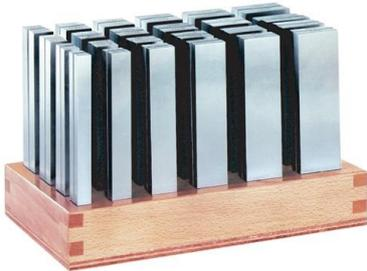
AMF Parallelunterlagensatz Nr. 6348P Inhalt 20 Paar Größe 100 Präzision Länge 100 mm · = Präzision im Holzkasten · einstückgehärtet · paarweise planparallel feingeschliffen · Sätze ergeben einen Bereich mit 1 mm-Stufung · Paartoleranz tp in der Höhe IT 5 Nennmaßtoleranz in der Höhe  $\pm 0,01$  mm restliche Maße nach DIN ISO 2768m
