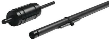
Hohlspindelanschlag für Spindel-Ø 32-41 mm · der Anschlag wird von hinten in die Hohlspindel eingesetzt und mit einem Spezialschlüssel angezogen · durch das Anziehen der Spannschraube werden die Spannbacken an die Innenwand der Hohlspindel gedrückt, dadurch ist ein sicherer Sitz des Anschlages gewährleistet · mit dem Schlüssel wird der Anschlag gelöst und in der Länge verschoben
