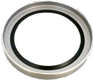
**WDR 95x120x12 B2PT PTFE Wellendichtring Form C, Metall VA, PTFE 10/F56101**
