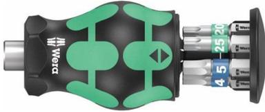
WERA Magazinbithalter K K Stubby Magazin 6-teilig TORX/6kant · mit 2-Komponenten-Kraftform-Griff · mit integriertem Bit Magazin · Bitaufnahme mit starkem Dauermagnet · bestückt mit BITorsions Bits zähhart · Bits mit Take it easy Farbleitsystem Eigenschaften: • Länge: 115mm • geeignet für: Bits 6,3 mm (1/4 ") ISO 1173-C Bestückung: je 1 Bit für Schrauben mit Innen-TORX®-Profil Gr. T 15 / 20 / 25 je 1 Bit für Schrauben mit Innensechskant-Profil Gr. 3 / 4 / 5 mm
